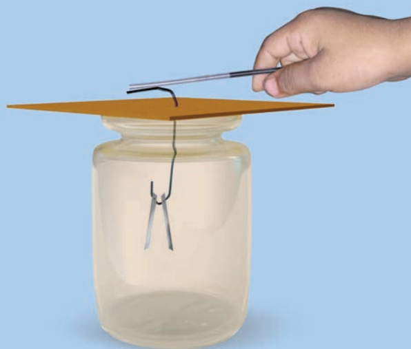
Fig 15.4 : A simple electroscope
